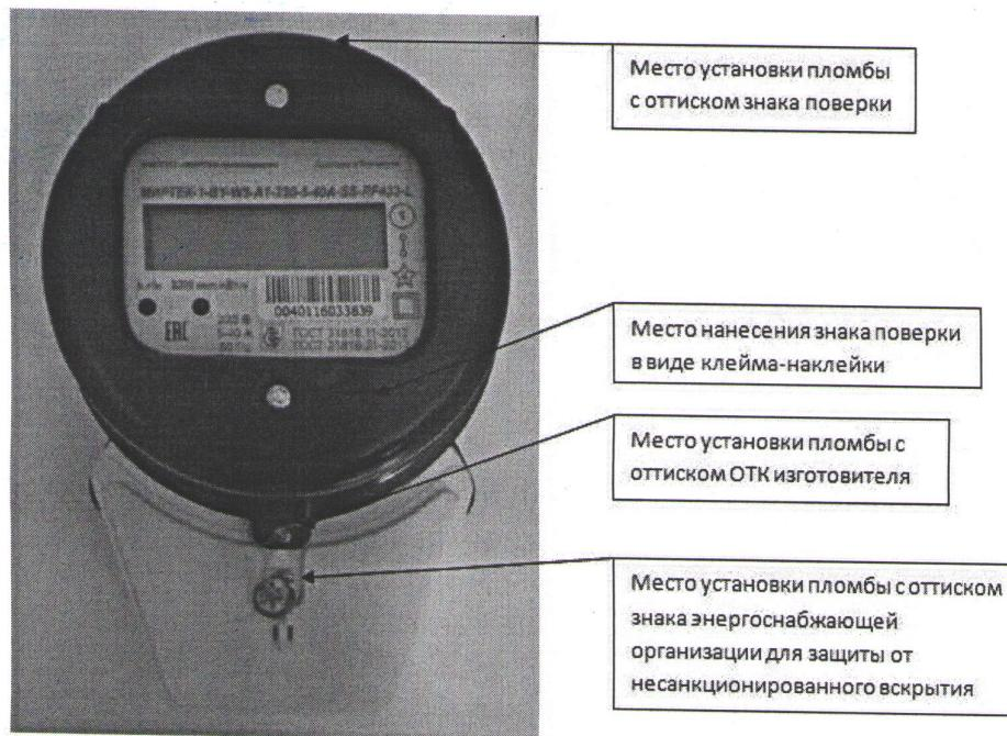
Рисунок А.4 – Места установки пломб и нанесения знака поверки для счетчиков в корпусе модификации W5
