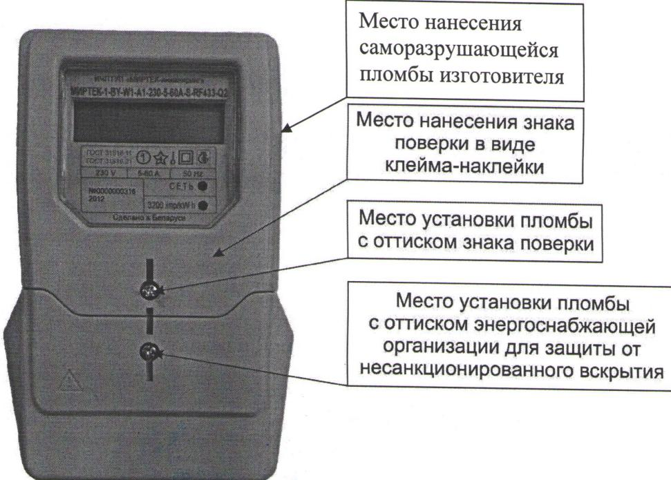
Рисунок А.1 – Места установки пломб и нанесения знака поверки
