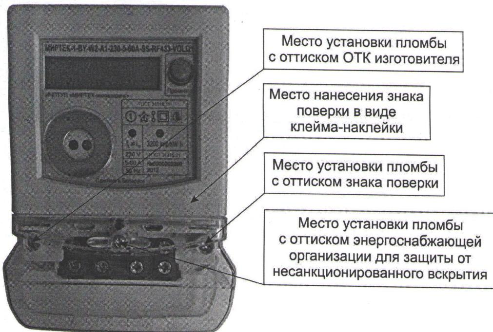
Рисунок А.2 – Места установки пломб и нанесения знака поверки
