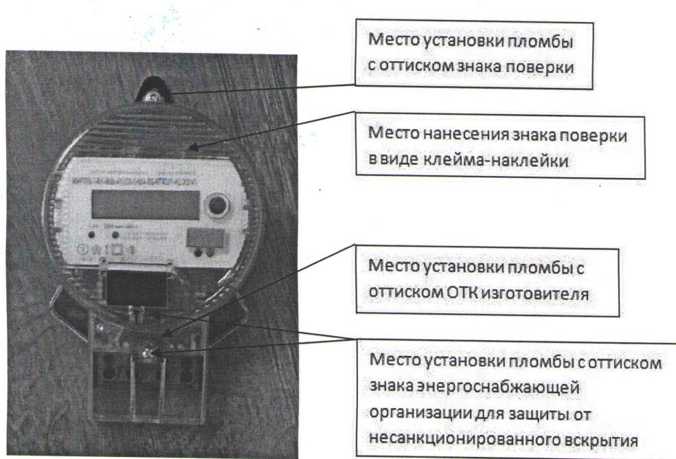
Рисунок А.6 – Места установки пломб и нанесения знака поверки для счетчиков в корпусе модификации W6b
